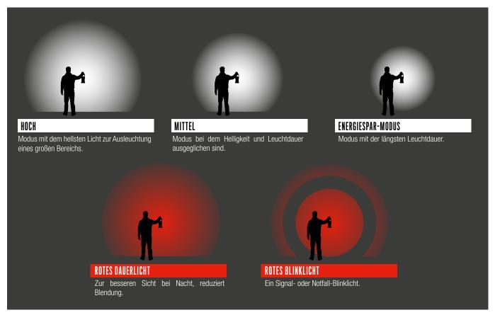
Durch die "EAL multi-mode" Technologie von COAST kann der Benutzer schnell von einem stromsparenden Modus in den höchsten Modus wechseln oder eine Zwischenstufe wählen. Auch in die Modi mit rotem Licht kann der Benutzer einfach und schnell wechseln.
